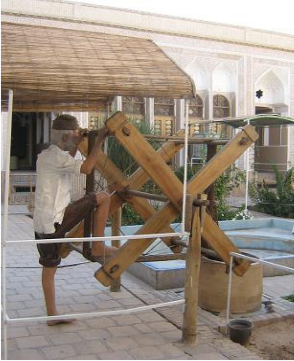
Şəkil 37. Kankan çarxı və onda işləyən kankan (İran İslam Respublikası, Yəzd Su muzeyi).
