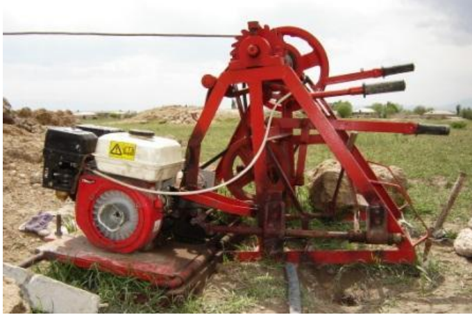
Şəkil 51. Kankan çarxını əvəz edən, əl ilə idarə olunan səyyari bucurqadlı yükqaldıran mexanizm
