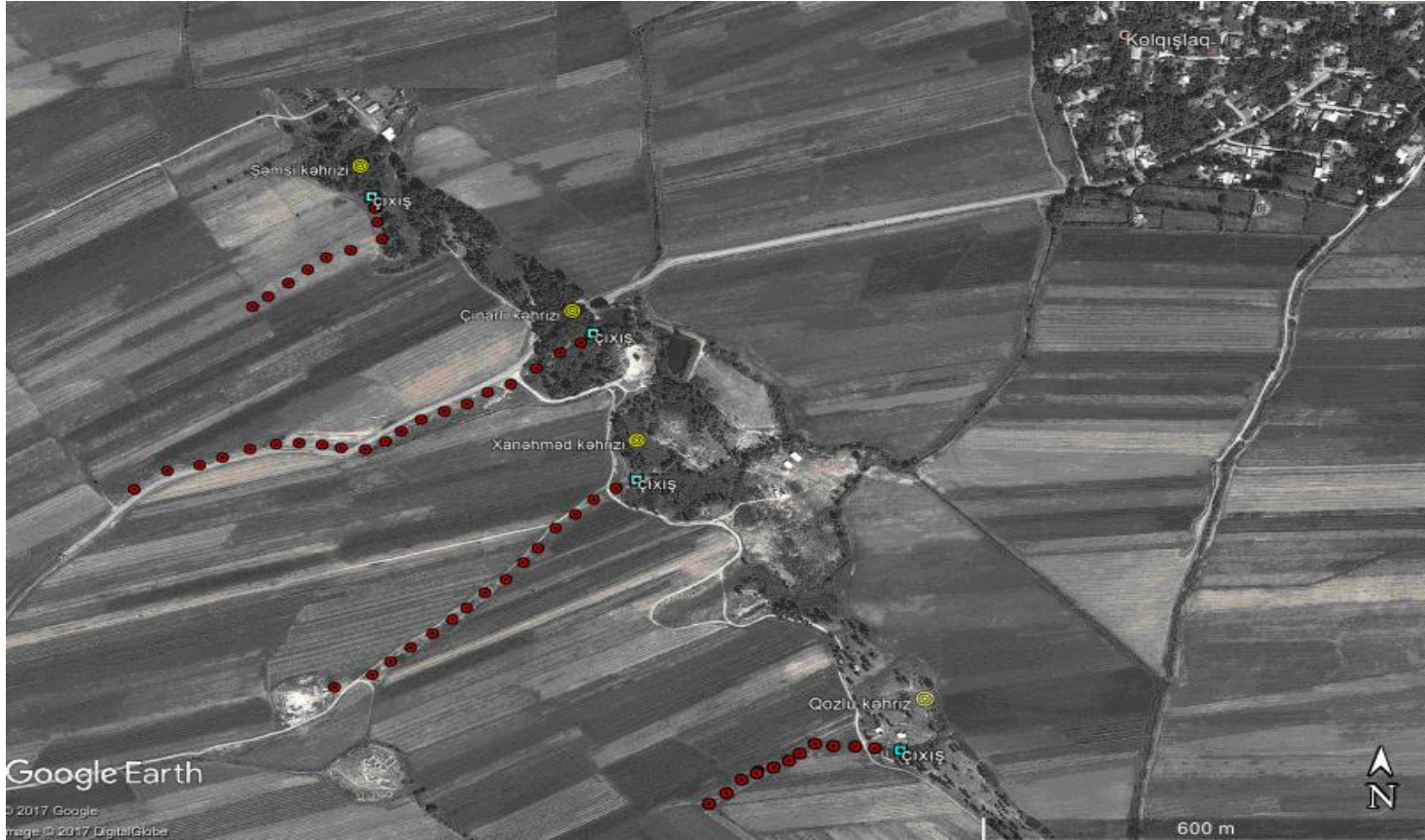
Şəkil 74. Ağdam rayonunda Korqışlaq kənd kəhrizlərinin sxematik planı
