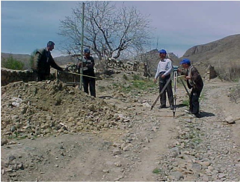
Şəkil 57. Qədim kəhriz quyuları üzərində geodeziya-ölçmə işləri aparılır.
