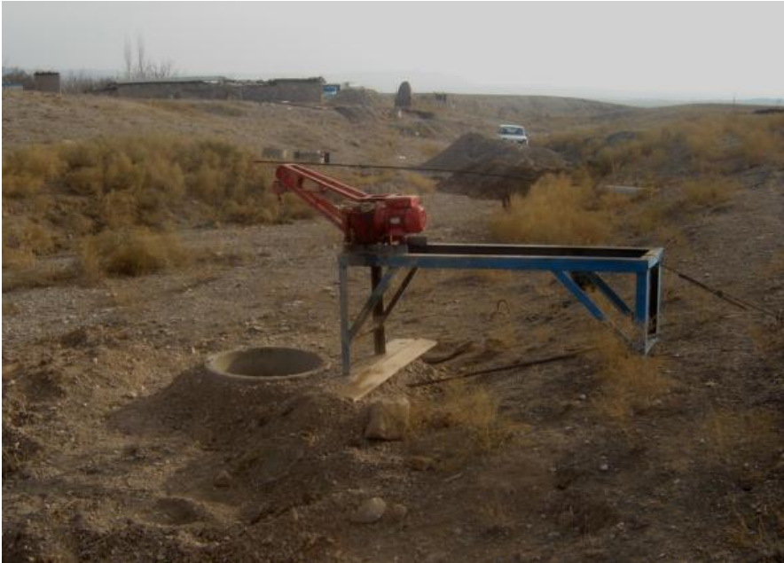
Şəkil 60. Kəhriz kürəsinə yükləri endirən və qaldıran səyyari bucurqad mexanizmi
